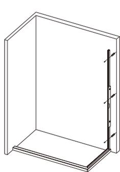
1. 首先将下侧包边卡卡在侧墙材底部,然后将卡在一起的侧包边和侧墙材一起放到石基上,侧墙材居石基中间,打水平,钻孔,打膨胀胶粒,最后将侧墙材打好螺丝固定在墙上。
