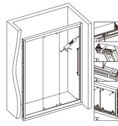
6. 确定开门空间后, 用内六角扳手将联动门定位块锁紧固定; 然后扣上墙材关门边的装饰条, 盖上固玻卡块和上下轮的螺丝装饰盖, 最后在地面和墙壁与淋浴房结合处涂上中性玻璃胶(24小时后使用)。
