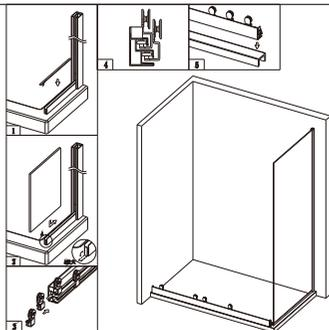
2. 撕掉不干胶垫片的保护膜贴在下侧包边内的侧固玻槽内(不干胶垫片的长度比侧固玻宽度短50MM即可)。然后将下侧包边转角处的卡边掰直,把侧固玻抬起放到侧包边的侧固玻槽内,然后推进侧墙材的玻璃槽内,最后再将下侧包边转角处的卡边掰回原状即可。接着将下轮活和下轮中按次序滑入下轨内,然后将装有下轮的下轨放置在石基的合适位置。
