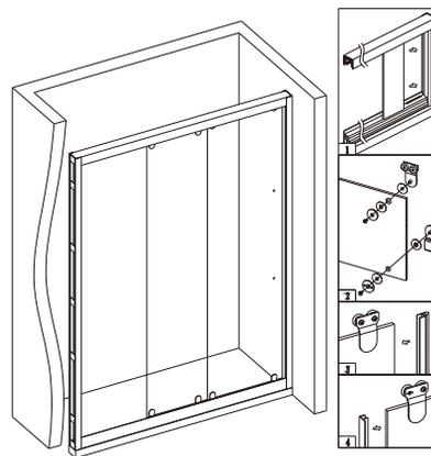
3. 将固玻放在下轨固玻槽的不干胶垫片上, 推进墙材槽内, 调整至合适位置; 将活玻中和活玻装在上下轨的轮子上, 同时将活玻装上磁条和F型胶条, 活玻中装上F型胶条(F型胶条的软边向房体外面)。
