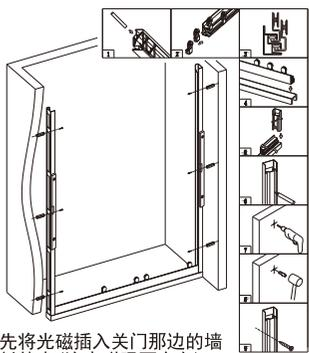
1. 首先将光磁插入关门那边的墙材塑料件内(注意磁吸面方向), 接着将下轮活和下轮中按次序滑入下轨内, 然后将装有下轮的下轨放置在石基上, 与两条墙材套好。打水平, 做记号, 钻孔, 打膨胀胶粒, 最后将两条墙材打好螺丝固定在墙上。
