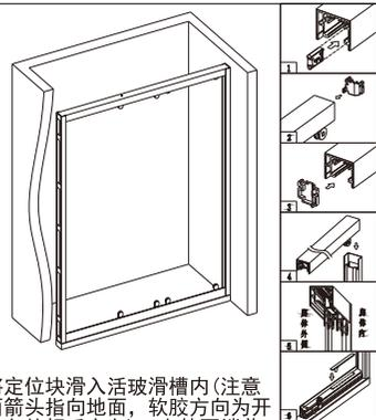
2. 将定位块滑入活玻滑槽内(注意背面箭头指向地面, 软胶方向为开门方向的相反方向), 上轨两端盖导轨盖, 然后将放有定位块和导轨盖的上轨放进墙材槽口, 固玻槽靠房体外侧; 撕掉不干胶垫片的保护膜贴在下轨的固玻位置处(不干胶垫片的长度比固玻宽度短50MM即可)。
