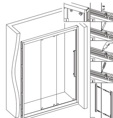
4. 调节上轮来达到磁条和墙材等垂直吻合(上轮为偏心结构, 可用内六角扳手通过上轮背面盖板侧的圆孔进行调节玻璃的上下位置); 可通过固玻在墙材槽内的深浅位置来调节玻璃之间的重叠位大小; 调节完成后将固玻卡块靠着固玻和下轨放置好, 做记号, 钻孔, 用螺丝锁紧在下轨上(钻孔的时候需要将活玻和固玻移下来放到一边再钻孔, 钻孔完成后再将活玻和固玻装回原来位置即可), 安装拉手。
