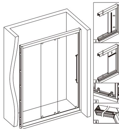
5. 调整整个房体, 滑轮滑动顺畅无异响, 磁条和墙材垂直吻合后, 将固玻与墙材接触位置打上单边胶条, 固玻与上轨槽接触位置打上单边胶条; 将下轮后背盖板的内六角机丝锁紧。导轨盖调整至墙材平齐后将机丝锁紧。
